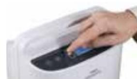
**6** Wählen Sie den Modus durch Drücken der Moduswahl-Taste (M) aus. Drücken Sie die Moduswahl-Taste mehrfach, um zwischen den Modi *Puls*, *Dauerflow* oder *Schlaf* hin- und herzublättern.
