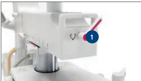
Abbildung 2: Veradius Unity mit Farbcodierung 1 Arretierung für Längsbewegung (pink) 2 Arretierung für Winkelbewegung (blau) 3 Arretierung für Drehbewegung (orange) 4 Arretierung für Schwenkbewegung (schwarz)
