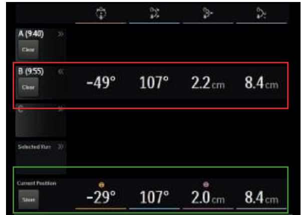
Abbildung 5: Benutzeroberfläche mit Position Memory und Anzeige der aktuellen Position (grüner Rahmen) und der gespeicherten Position (roter Rahmen)
