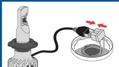
Verbinden Sie den Fahrzeugstecker mit der LED-Lampe
