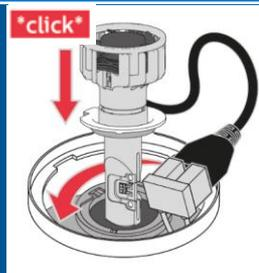
Setzen Sie die LED-Lampe in die Feder-Halterung des Scheinwerfer ein und verstauen Sie das Kabel unter der Scheinwerfer-Abdeckung
